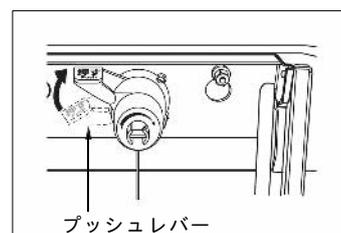
(2)ハンドルを軸に差し込んで時計回りに回します。はしごが完全に収納されるまで回します。
